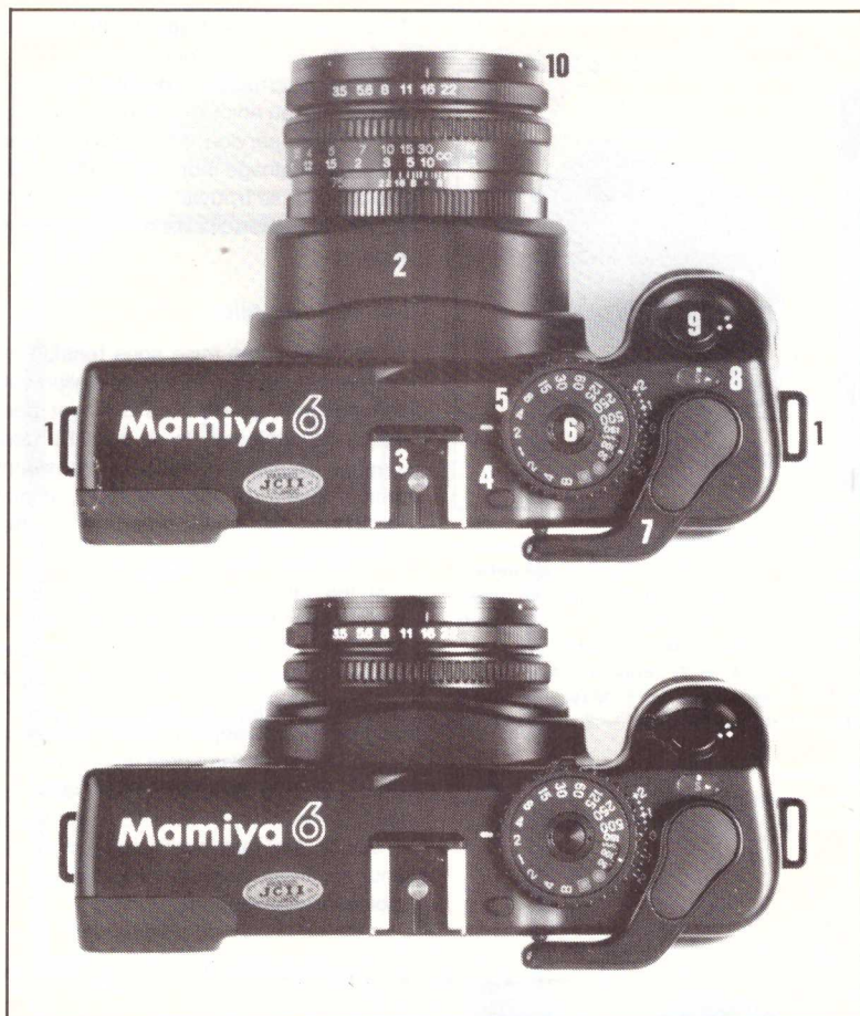
Mamiya 6 vu de dessus, muni de son objectif standard de 75 mm, en haut objectif sorti, en bas rétracté : 1. Attaches de sangle pour portage horizontal du boîtier. — 2. Platine porte-objectif rétractable sur 31 mm. — 3. Griffes porte-accessoires à contact central de synchronisation. — 4. Poussoir de déverrouillage du correcteur d'exposition. — 5. Barillet des vitesses/sélecteur de sensibilité. — 6. Poussoir de déverrouillage des positions \circ et \square du barillet. — 7. Levier d'armement rapide en une action de 185. — 8. Compteur. — 9. Déclencheur, entouré de l'interrupteur général. La position rétractée assure à l'appareil une compacité très appréciable qui lui permet de trouver une place pratiquement partout, grâce à une réduction d'épaisseur de 31 mm.
