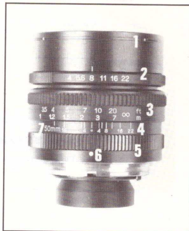
Objectif de Mamiya 6 vu de dessus : 1. Baïonnette pour la fixation du parasoleil. — 2. Bague de diaphragme, crantée par valeurs entières. — 3. Bague des distances. — 4. Echelle de profondeur de champ (avec repère de correction pour l'emploi de films infrarouges). — 5. Bague fixe pour le montage/démontage de l'objectif (plutôt rare de nos jours !). — 6. Repère de positionnement sur le boîtier. — 7. Rappel de la focale, visible en position de prise de vue.
