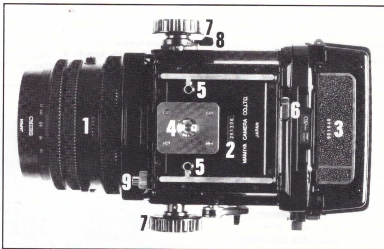
Semelle du Mamiya RB 67 Pro-SD : 1. Objectif (le numéro de série est visible à-côté du repère). — 2. Boîtier (le numéro de série est visible à-côté du repère). — 3. Dos-magasin 120 (le numéro de série est visible à-côté du repère). — 4. Embase taraudée pour fixation sur pied \varnothing 5/8" (pas du Congrès), avec réducteur 1/2" (pas Kodak). — 5. Alvéoles de positionnement pour les accessoires de semelle, et rails rectifiés assurant la stabilité du boîtier. — 6. Levier de déverrouillage de l'adaptateur rotatif. — 7. Boutons de mise au point. — 8. Levier de verrouillage de la mise au point. — 9. Déclencheur.
