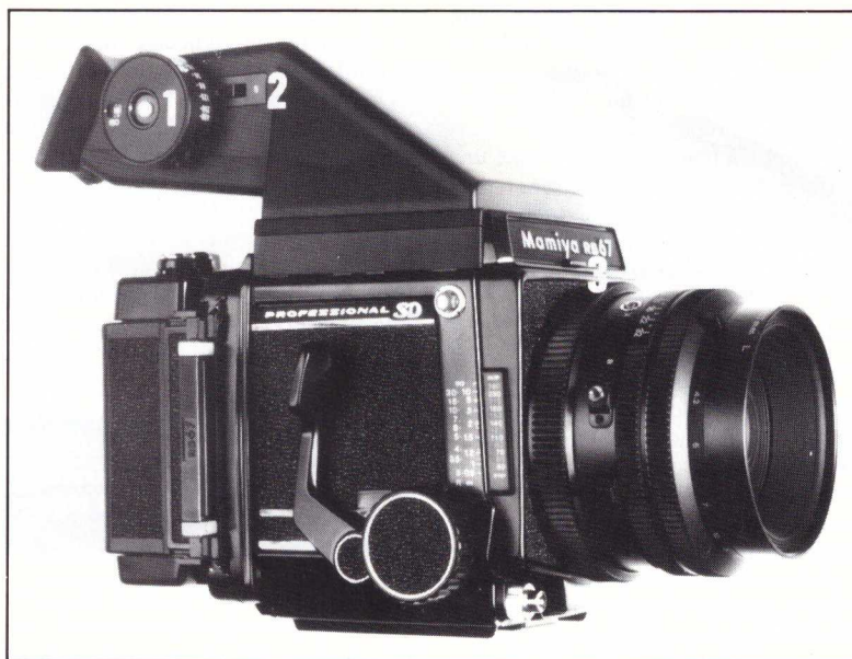
Mamiya RB 67 Pro-SD équipé du prisme/posemètre silicium, sur lequel on remarque : 1. Le barillet de sélection de sensibilité et ajustage d'exposition avec, en son centre, le poussoir blanc de mise sous tension. — 2. L'inverseur A-S permettant de commuter la mesure intégrale pondérée ou la mesure sélective. — 3. Le curseur de déverrouillage de la plaque frontale, qui permet de démonter le viseur.
