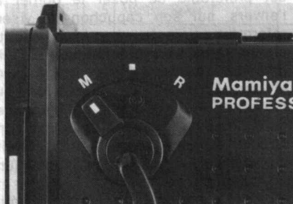
Position du levier R-M pour effectuer des expositions multiples, ainsi que lorsqu'on utilise d'autres dos que les magasins roll-film RZ (dos Polaroid, adaptateur G/RZ).
