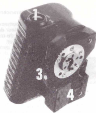
La poignée-moteur N : 1. Déclencheur et sa couronne de sélection de fonction. - 2. Platine de couplage mécanique (verrouillage et entraînement). - 3. Levier de verrouillage et son verrou. - 4. Renvoi de la commande de surimpression.
