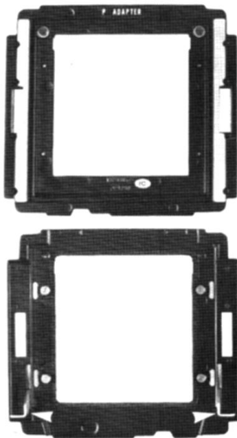
Adaptateur P, en haut côté verrouillage P, en bas côté verrouillage R. Les deux flèches montrent les deux curseurs de verrouillage du dos Polaroid (ici déverrouillé).
