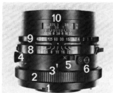
Objectif Mamiya Sekor C de 90 mm vu de dessus : 1. Encoche de verrouillage de la bague de serrage après chaque déclenchement. - 2. Bague de serrage. - 3. Repères de positionnement. - 4. Inverseur pour prise de vue miroir relevé et prise pour déclencheur souple. - 5. Sélecteur de synchronisation X/M. - 6. Prise de synchronisation coaxiale. - 7. L'un des deux bossages de manœuvre de la bague du diaphragme. - 8. Bague du diaphragme. - 9. Bague des vitesses. - 10. Echelle des distances et de profondeur de champ.
