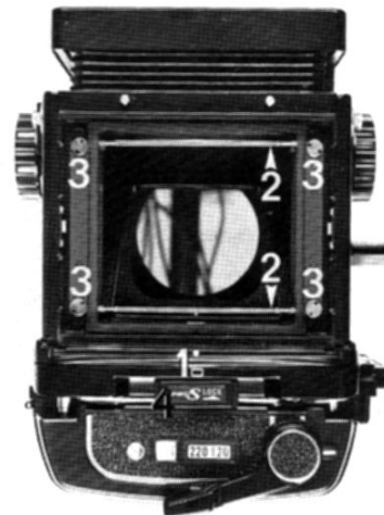
Viseur capuchon du Mamiya RB 67 Pro-S : 1. Loupe interchangeable (les deux points blancs servent de repère de montage). - 2. Poussoir de mise en place de la loupe.
