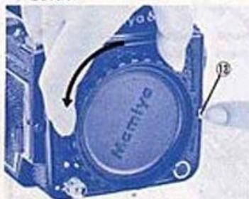
Appuyer sur le bouton de verrouillage d'objectif, tourner le bouchon de boîtier dans le sens inverse des aiguilles d'une montre et enlever le bouchon. Pour enlever le couvercle supérieur du boîtier, le glisser simplement en arrière et le soulever.
