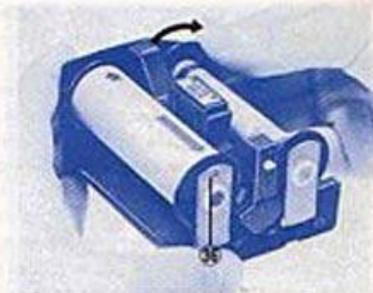
7. Tourner doucement la bobine réceptrice jusqu'à aligner la flèche de départ sur le papier du film avec le repère (36) sur le clip.
