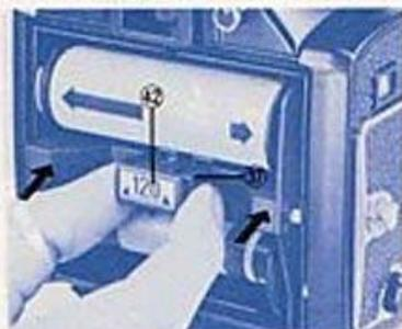
1. Attraper la cassette par les deux cliquets de fixation en les pinçant (37) en s'assurant que l'index (42) est bien dans le bon sens et enfoncer la cassette bien droite. Arrivé au fond, relâcher les cliquets.
