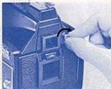
Tourner à fond le bouton de démontage dans le sens inverse des aiguilles d'une montre (180°) et presser dessus.
