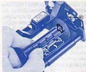
3. Engager le trou de droite de la bobine vide dans l'axe d'entraînement du bas (41). Ramener ensuite le clip de fixation (38) en s'assurant que le téton s'engage bien dans le trou de la bobine.
