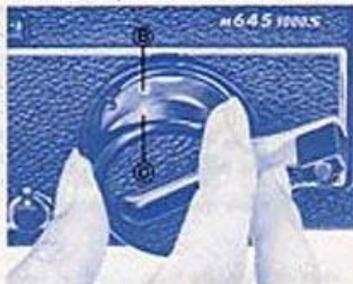
1. Aligner le point rouge (B) du boîtier avec l'index (C) de la manivelle d'avancement du film.
