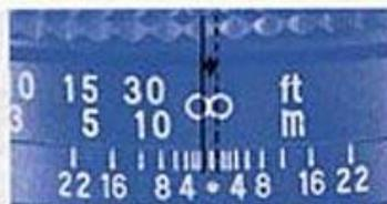
Quand on utilise des films infra-rouges, il est nécessaire de modifier la mise au point pour ramener l'image dans le plan du film. Cette modification est particulièrement importante quand :
