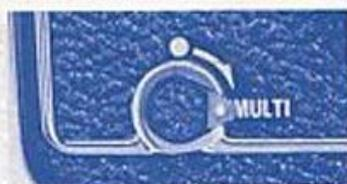
Quand le point blanc du levier de surimpression (25) est aligné sur la position "multi", le mécanisme de protection contre les doubles expositions est désengagé, aussi l'obturateur peut-il être réarmé grâce au bouton d'avancement du film, sans que le film bouge, rendant ainsi la surimpression possible (Si vous faites de la surimpression, le compteur ne bouge pas).
