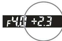
4. Lorsque le déclencheur est légèrement sollicité, la différence entre les réglages choisis et la valeur mesurée par l'appareil apparaît dans le viseur. Elle s'affiche par incréments de 1/3 IL dans une plage de  $\pm 6$  IL.
