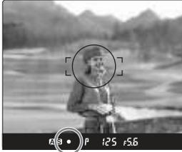
Indicateur de mise au point allumé ● la mise au point est correcte
