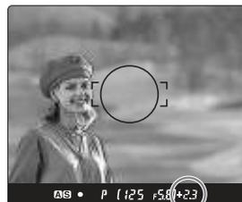
Maintenez la commande A de mémorisation de l'exposition automatique (AEL) enfoncée et l'afficheur ACL du viseur vous indiquera le différentiel entre les paramètres d'exposition calculée et ceux du cadrage définitif. Cette fonction est bien pratique pour vérifier la présence ou non d'objet à très fort niveau d'éclairément dans votre prise de vue.
