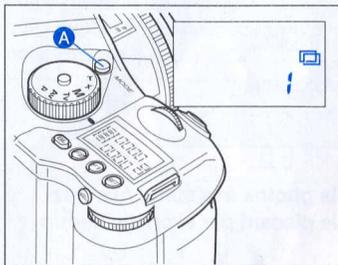
1. Pressez deux fois la commande de sélection de mode **A** pour sélectionner le mode surimpression.
