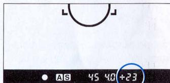
4. Lorsque le déclencheur est légèrement sollicité, la différence entre les réglages choisis et la valeur mesurée par l'appareil apparaît dans le viseur. Elle s'affiche par incréments de 1/3 IL dans une plage de  $\pm 6$  IL.
