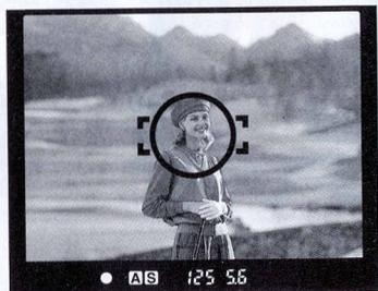
Indicateur de mise au point ● Allumé.....La mise au point est correcte
