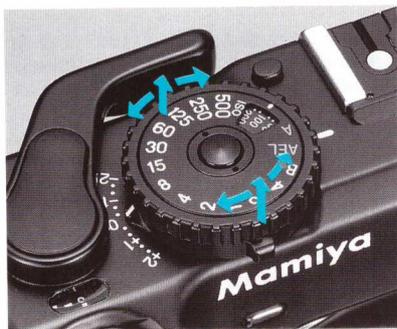
Avant de charger un film, il faut positionner la sensibilité (ISO). Soulever le cadran des vitesses et le positionner sur la valeur ISO choisie.
