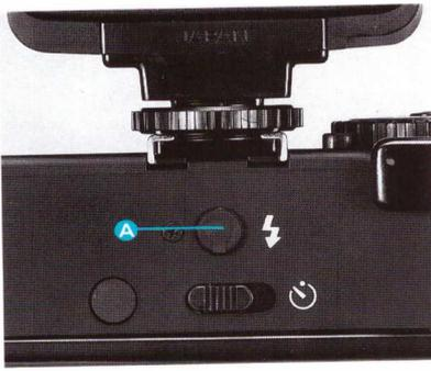
Le MAMIYA 6 MF a pour caractéristique la synchro flash à toutes les vitesses. Le sabot du flash peut être fixé sur la griffe porte accessoires ou une barrette peut être fixée par la vis trépied à la base du boîtier. Oter doucement le couvercle (A) pour mettre votre cordon synchro.
