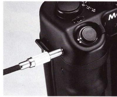
Lorsque l'on travaille en pose longue plus de 4 secondes, il faut se mettre sur "B". Dès que le bouton est enfoncé l'obturateur s'ouvre. Pour éviter tout mouvement du boîtier, il est préférable d'utiliser un câble déclencheur et un trépied.
