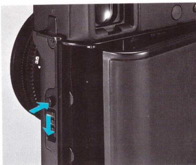
Tandis que vous appuyez sur le bouton de déverrouillage du dos, appuyez vers le bas sur la commande d'ouverture du dos comme indiqué par les flèches et le dos s'ouvrira. Pour la fermeture, rabattre le dos et l'appuyer contre le boîtier jusqu'au verrouillage.
