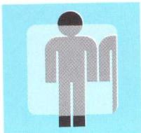
Lors de la mise au point de l'objectif, le télémètre superpose 2 images dans le carré central.
