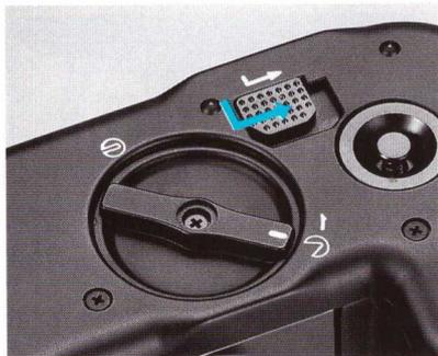
1. Avant de photographier, insérer le cache de format 4,5×6 sous les guides d'avancement du film en s'assurant d'abord d'avoir ouvert le rideau. Si le cache est inséré sans que le rideau soit ouvert, vos doigts peuvent accrocher ce dernier et l'endommager.
