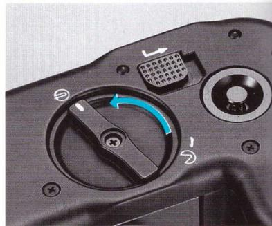
Tourner la commande de fermeture dans le sens de la flèche et aligner le tiret blanc sur le symbole "⊖".
