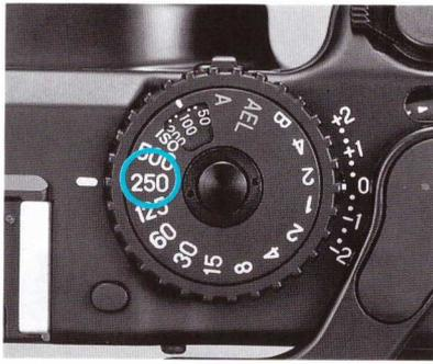
Vous pouvez débrayer le mode automatique et passer en semi-automatique, ayant ainsi la possibilité de régler votre vitesse d'obturation. Il suffit de positionner la vitesse choisie sur l'index blanc du boîtier et de sélectionner une ouverture.
