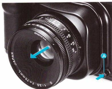
1. Appuyer sur le bouton de déverrouillage (A) du boîtier comme indiqué et tirer l'objectif et la monture.
