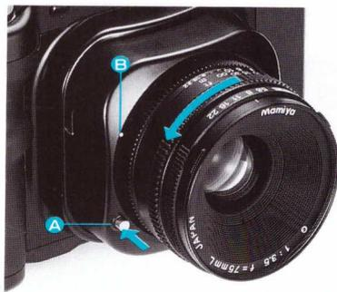
Comme pour le bouchon du boîtier, il faut appuyer sur le bouton de déverrouillage de l'objectif (A) et tourner l'objectif dans le sens de la flèche jusqu'à l'alignement de l'index de l'objectif avec celui du boîtier (B).
