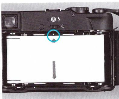
5. Avancer le film à l'aide du levier d'avancement jusqu'à l'alignement de la flèche du film sur l'index de départ du film (▼) sur le boîtier. Puis fermer le dos.
