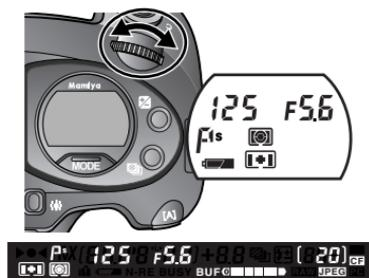
En mode de décalage de programme, l'icône de décalage de programme [Ps] apparaît sur l'écran LCD du viseur et sur l'écran LCD supérieur.
