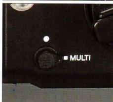
Il est possible d'exposer plusieurs fois la même vue en pressant le levier de surimpression du boîtier. Lorsque ce levier est pressé, le levier d'entraînement est déconnecté pour empêcher l'avance du film et l'obturateur est armé pour exposer une nouvelle fois la vue.
